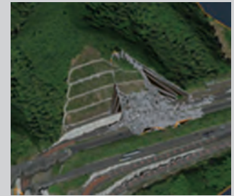
3次元データを活用した崩落土量の算出 Calculation of the collapsed soil amount using 3D data
