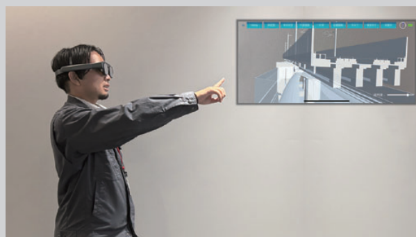
スマートグラスを用いたBIM/CIMモデル閲覧 Viewing BIM/CIM Models Through Smart Glasses
